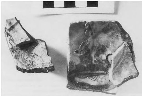
تصویر ۲۹. چسبیدگی لعاب دو ظرف به یکدیگر در طول فرایند پخت در کوره.
