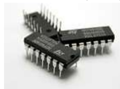
شکل (۲-۳) چند تراشه در بسته DIP14.
