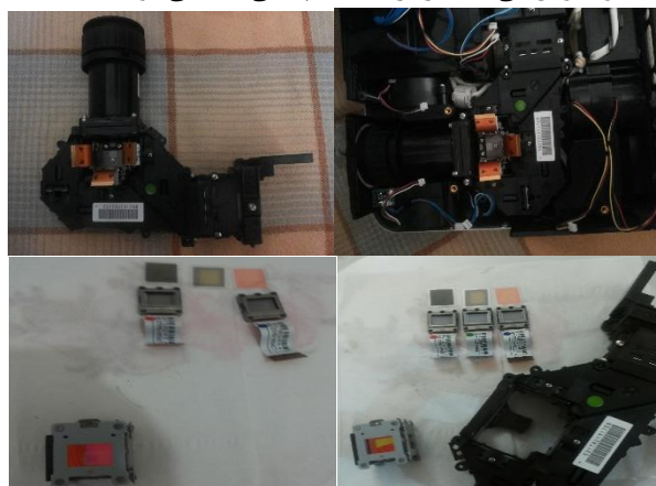
شکل (۷): تصویر قسمت اپتیکی پروژکتور و ال سی دی های آن
