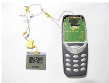
شکل(۳): ساخت مدولاتور فضایی نور با استفاده از صفحه
