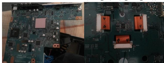
شکل (۶): تصویر سمت راست محل اتصال ال سی دی ها به برد
