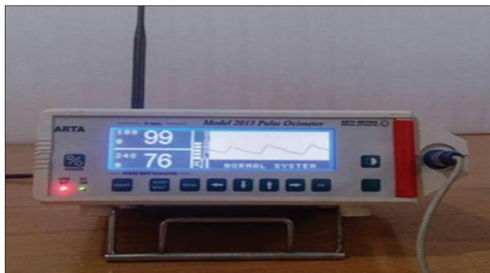
دستگاه پالس اکسیمتر خون جهت اندازه‌گیری درصد اشباع اکسیژن خون با قابلیت ارسال اطلاعات
