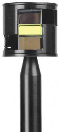
منشور (گونیای) مساحی وسیله‌ای است که از آن برای یافتن زاویه قائم و زوایای  $30^\circ$  و  $60^\circ$  درجه استفاده می‌شود.
