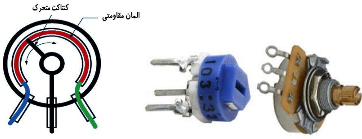
شکل ۱-۳: پتانسیومتر و ساختار داخلی آن
