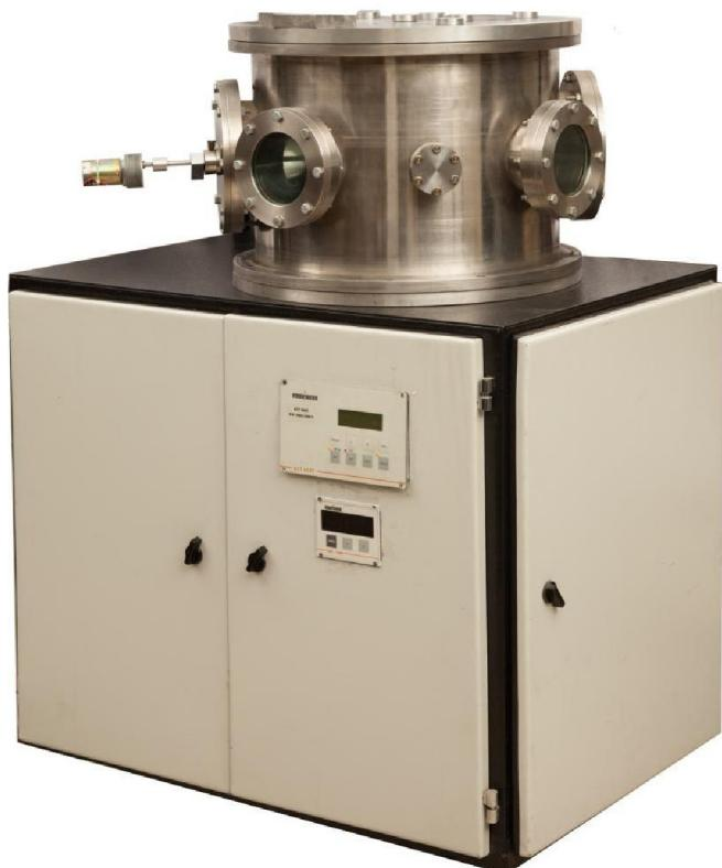
این دستگاه جزء آخرین تولیدات شرکت پوشش های نانو ساختار می باشد که با ابعاد کوچک و قیمتی بسیار مناسب قادر است به روش اسپاترینگ اقدام به لایه نشانی هدفهای فلزی مانند طلا، نقره، پلاتین، مس، آلومینیوم و... کند. با کنترل اتو ماتیک یا دستی فرایند خلاً سازی و لایه نشانی میتوان لایه هایی با دقیقیت ضخامت ۱ نانومتر تولید کرد. دستگاه فوق برای ایجاد لایه های نانو متري ، ایجاد اتصالات الکتریکی بسیار ظریف در حوزه نانو تکنولوژی و میکرو الکترونیک بسیار قابل استفاده می باشد.
